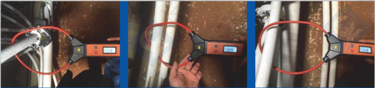
现场A、B、C三相接地环流实测数据
